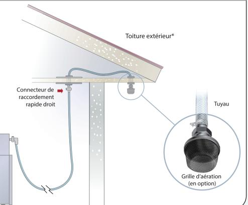
\* Remarques : Les directives de l'AAMI recommandent pour tous les stérilisateurs à OE de prévoir un tuyau d'échappement dédié à l'appareil, avec une évacuation directe vers l'extérieur ou par l'intermédiaire d'un dispositif antipollution. Le conduit d'évacuation doit déboucher à plus de 7,6 m de toute prise d'air frais du bâtiment ou de toute voie de circulation de piétons ou d'animaux, et doit empêcher l'oxyde d'éthylène d'être libéré dans le bâtiment ou d'y être aspiré.
